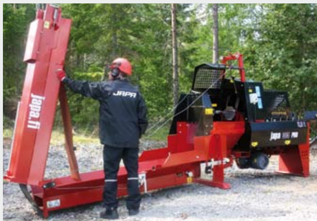
Keskelt kokkupandava väljastuskonveieri saab hõlpsalt töötöövõlms seada vintsi abil.
