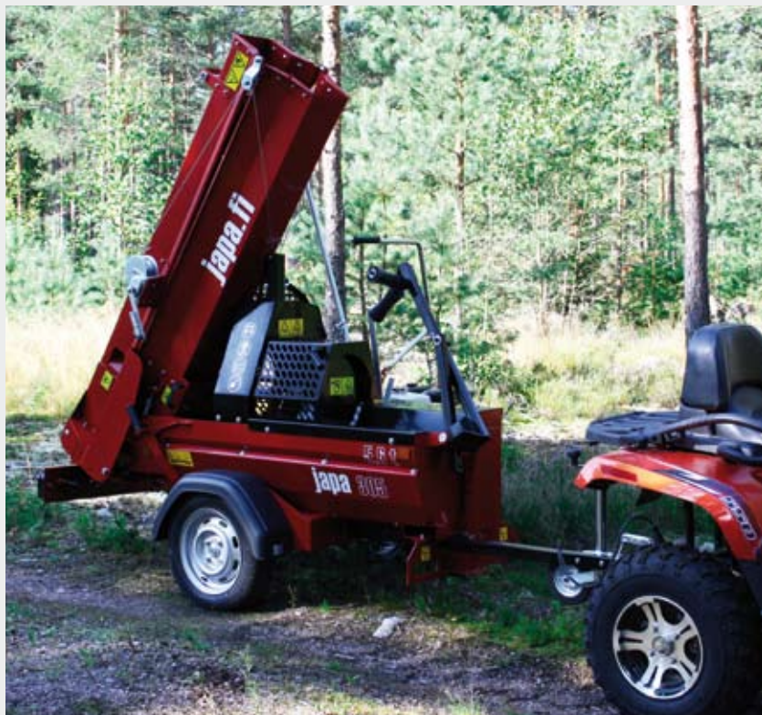
JAPA 305 BE ja E mudelitele saab tellida kerg-ja maantee telje-ga. Telg on vedrustatud ja varustatud 155/70x13 rehvidega. Maksimaalne lubatud kiirus – 80 km/h
