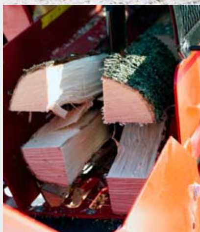
Puude lõhkumine toimub hüdrauliliselt, standardkomp- lekti kuulub 2/4 osaks lõhestav kirvetera.
